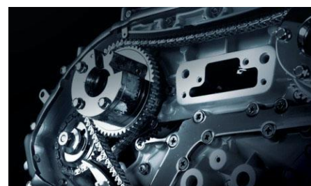
Новый бензиновый двигатель 1.6 H4M 113 л.с. с цепным приводом ГРМ
