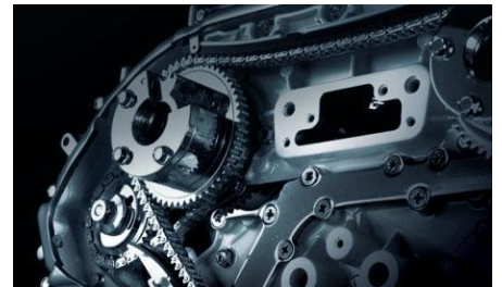
Новый бензиновый двигатель 1.6 H4M 113 л.с. с цепным приводом ГРМ
