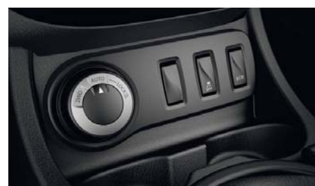
Система постоянного полного привода All-Mode 4X4
